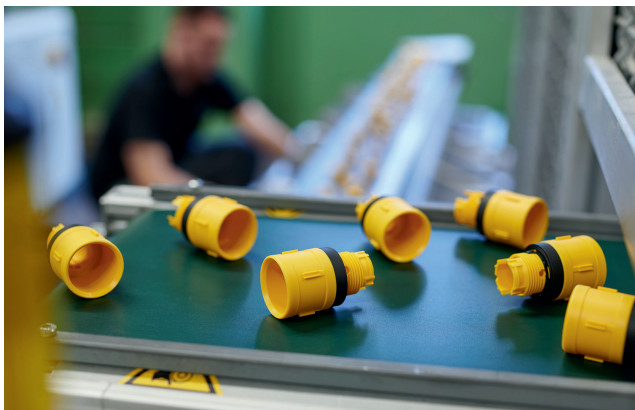
Bild 1. Das Spektrum der Spritzgussteile im Werk Dausenau umfasst rund 700 Produkte mit einer Stückzahl bis 12,5 Millionen pro Monat
