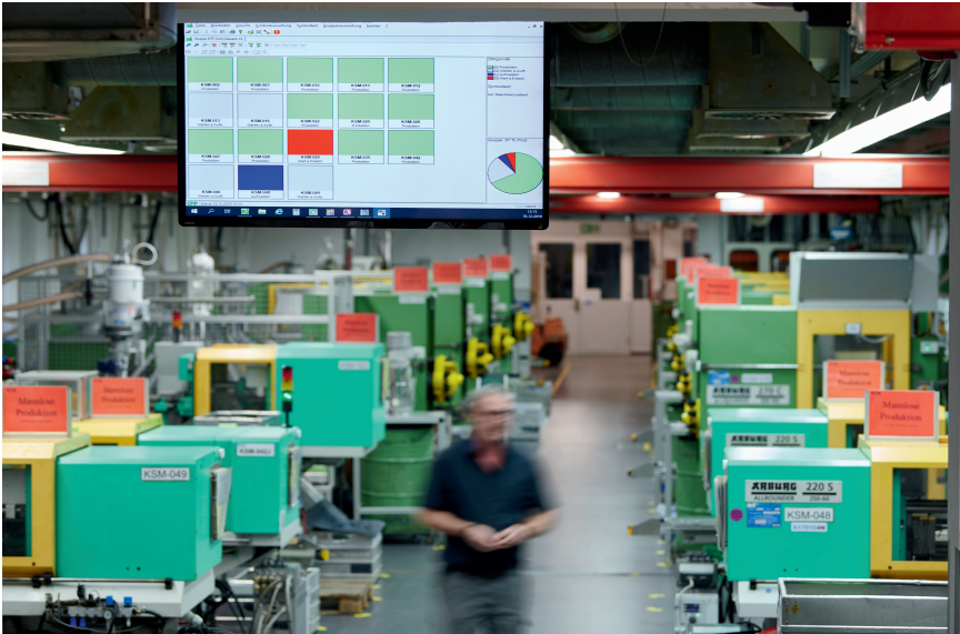
Bild 4. In beiden Werken befinden sich überall dort Terminals, wo Daten eingegeben oder aktuelle Daten benötigt werden © GRP / Gerd Arnolds
